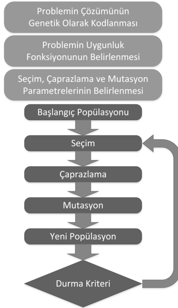
Şekil 4.1. Genetik Algoritmanın temel çalışma yapısı
